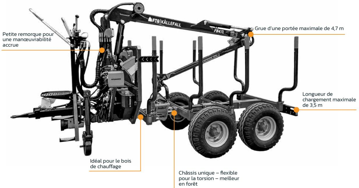
La remorque forestière standard FB50 est équipée d'un châssis à poutre centrale, d'un système de freinage hydraulique sur 2 roues, d'un timon droit avec anneau de remorquage rotatif de Ø50 mm, d'une base de grue solide avec des pieds de support repliables hydrauliquement, de boucles de levage soudées pour la courroie de tension, de 2 ranchers ajustables avec 4 piquets, et de roues 11,5/80-15,3.
