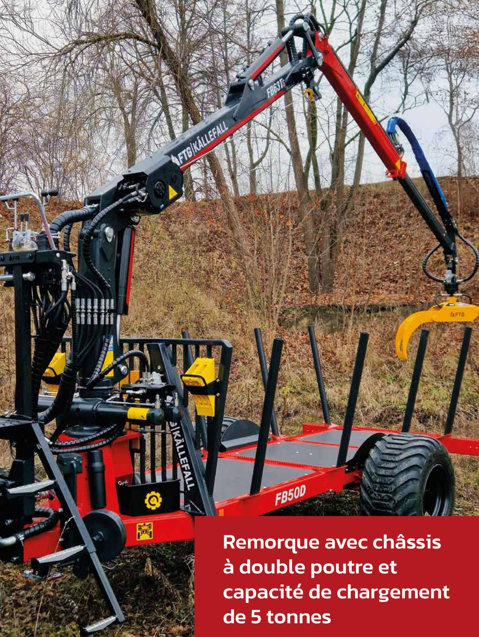
**Remorque avec châssis à double poutre et capacité de chargement de 5 tonnes**
